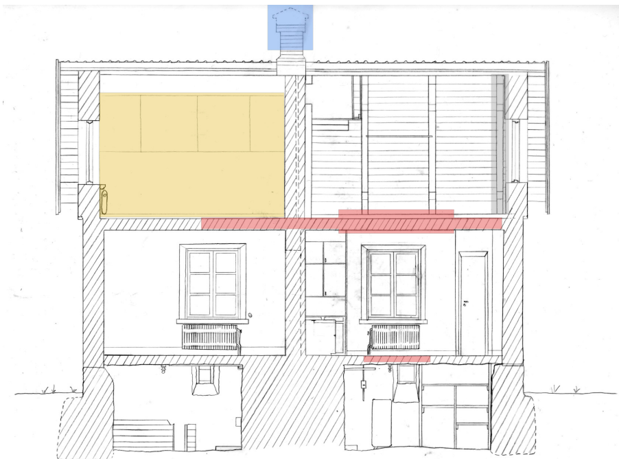
Schematisk illustration över de större interiöra skadorna
