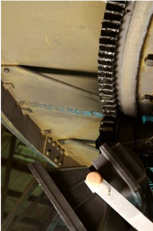
Matarbordets undersida med kugghjulet som drev det runt tornet.
